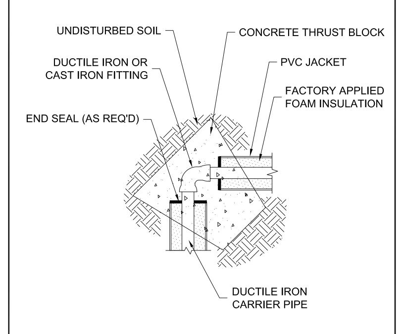
DUCTILE IRON THRUST BLOCK DETAIL N.T.S.
