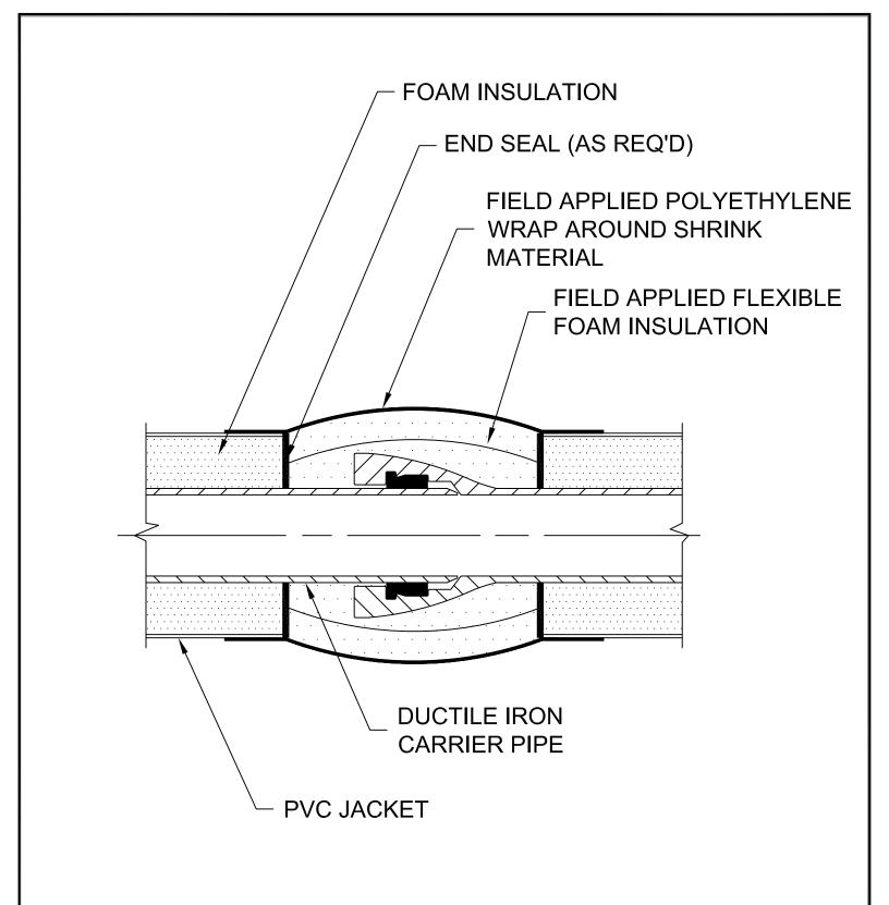
INSULATED DUCTILE IRON COUPLING JOINT N.T.S.
